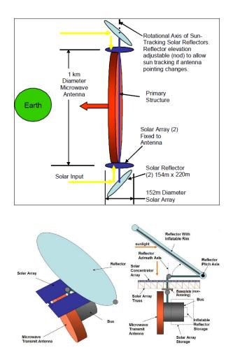
Fig. 6. Naval Research Lab (NRL) 5 MW SSP Concept<sup>20</sup>
